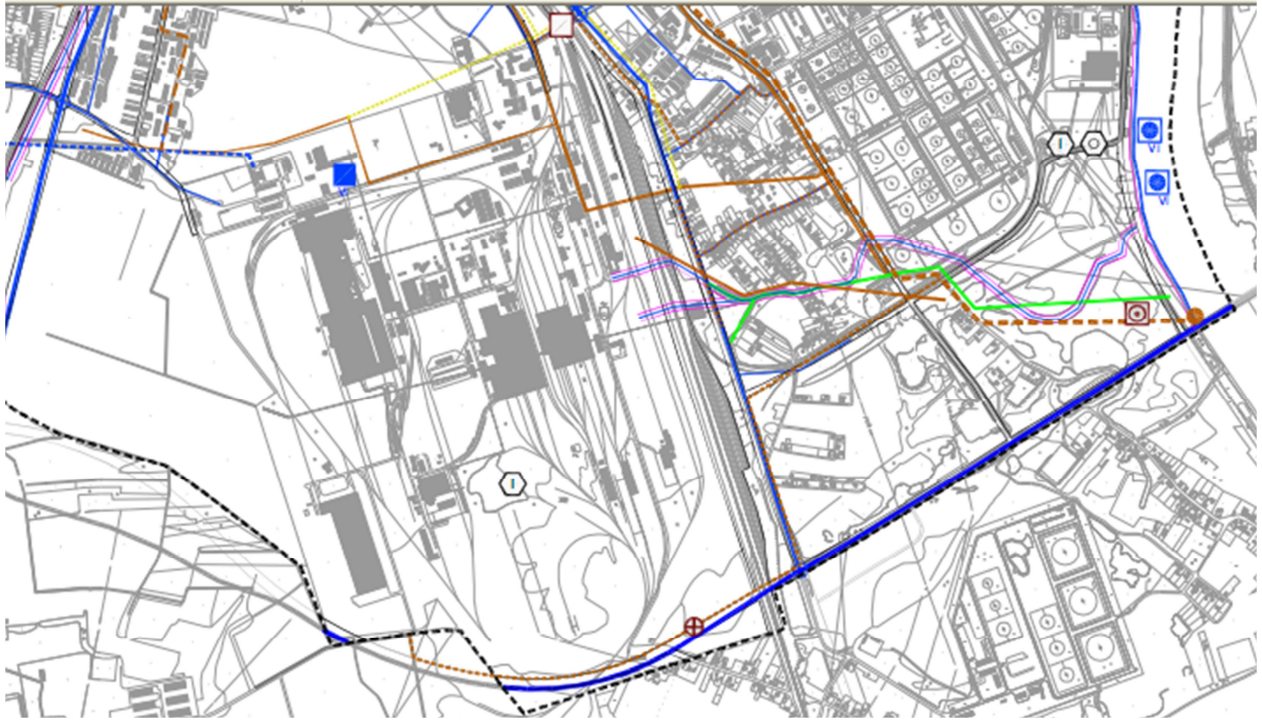
Izvod iz GUP-a Grada Siska: sustav javne vodoopskrbe i odvodnje
