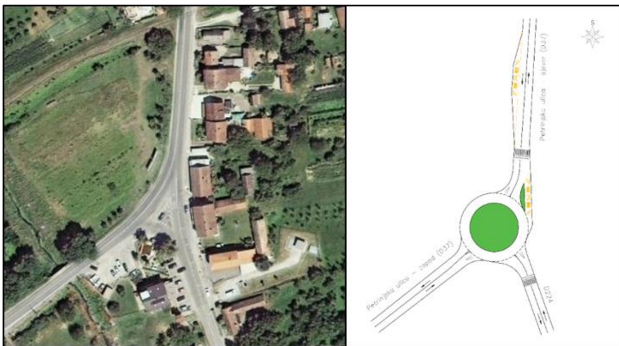
Slika 21. Postojeće stanje raskrižja Petrinjska ulica (D37) i D224 (lijevo) i idejna tlocrtna skica predložene rekonstrukcije u mini kružno raskrižje (desno)
