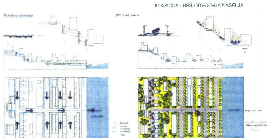
Slika 73 Klasični i NBS sustav odvodnje (autorski grafički prikaz)
