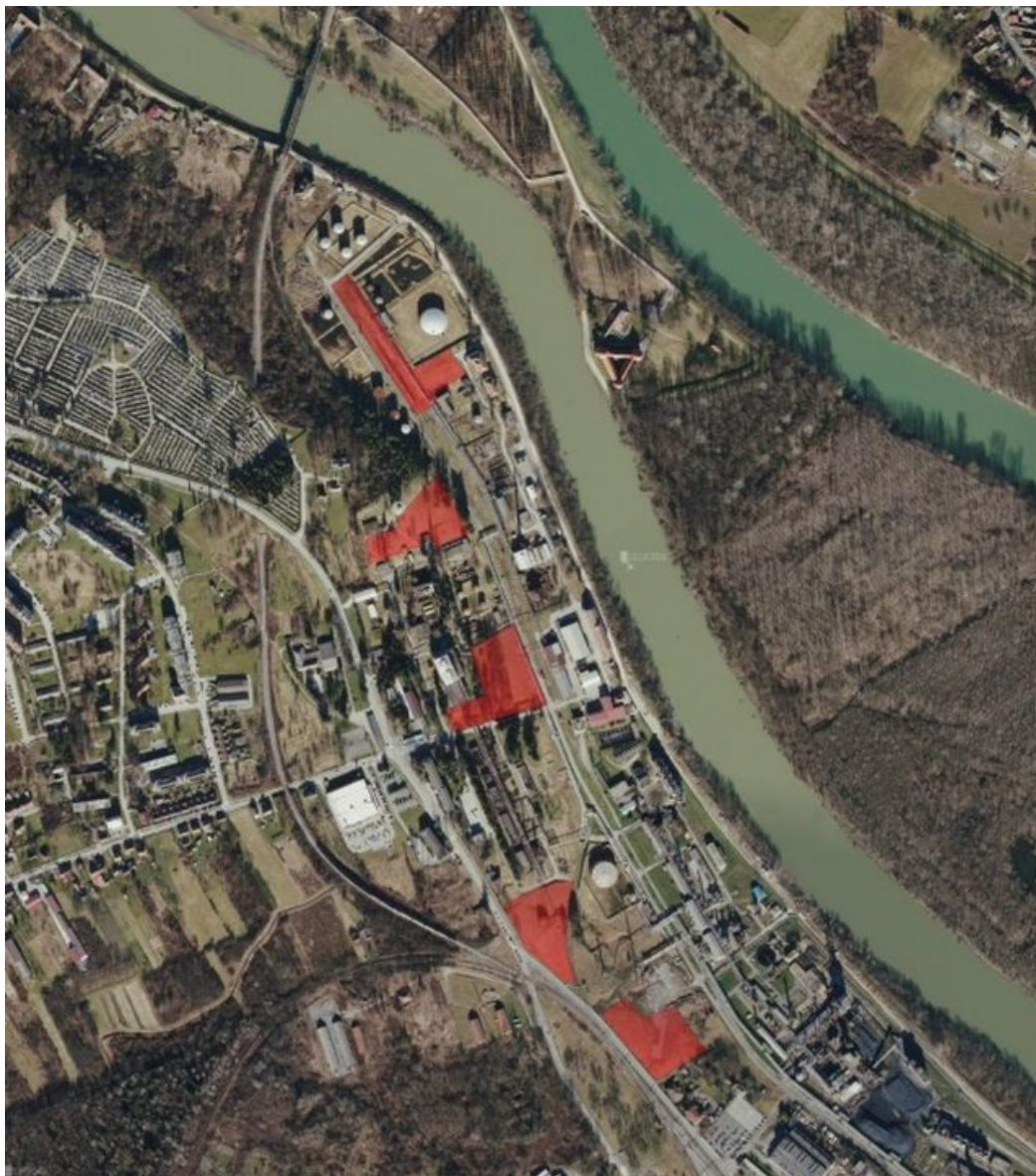
Slika 8 Izvod iz elaborata tvrtke Dvokut Ecro d.o.o. gdje su crvenom bojom označena područja na kojima se planiraju postaviti fotonaponski moduli u krugu sisačke rafinerije, izvor: https://mzoe.gov.hr/
