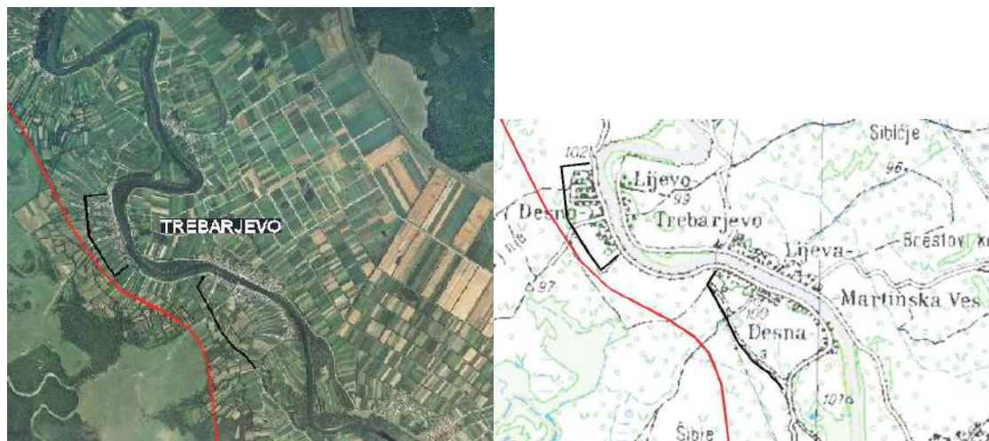
Slika 2-43 Situacijski prikaz nasipa kod Trebarjeva
