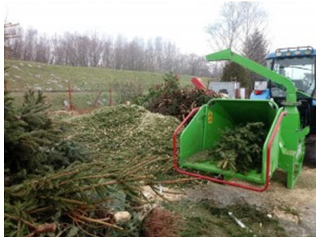
Slika 7. Odbačene drvene sječke i izrezivanje u drobilici za proizvodnju sječke
