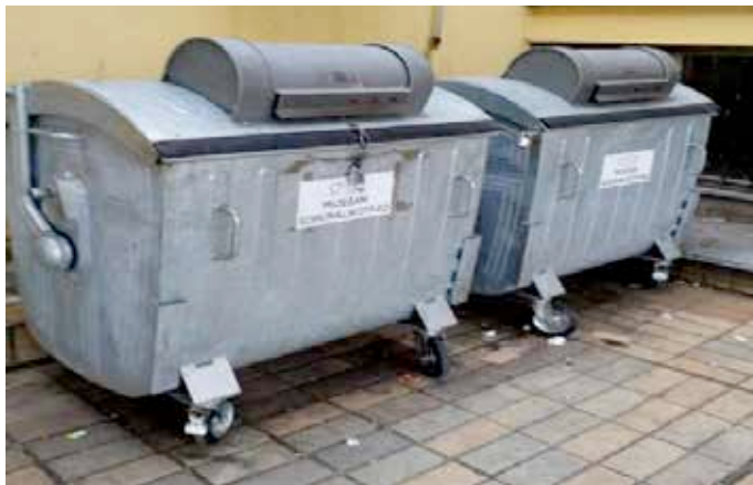
Slika 11.: Ugrađeni otpadomjer na kontejner od 1100 l
