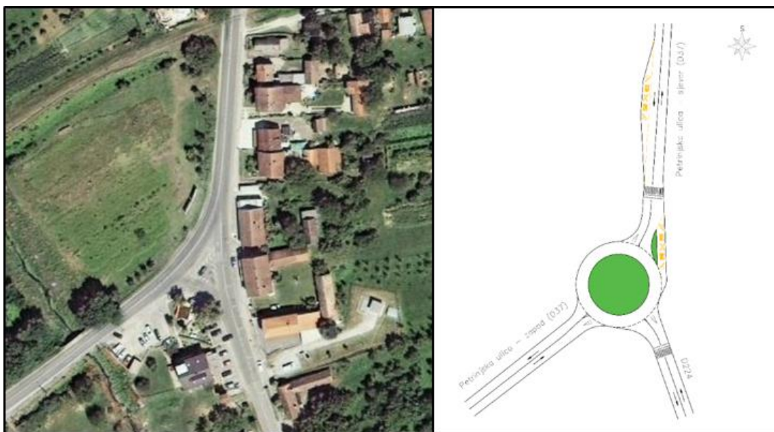
Slika 20. Postojeće stanje raskrižja Petrinjska ulica (D37) i D224 (lijevo) i idejna tlocrtna skica predložene rekonstrukcije u mini kružno raskrižje (desno)
