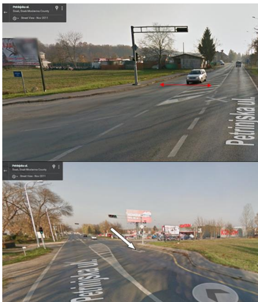
Slika 17. Primjer moguće optimizacije semaforiziranog raskrižja dodavanjem dodatnog prometnog traka ukoliko ima raspoloživog prostora (raskrižje Petrinjska (D37) – Capraška („kod Konzuma“))
