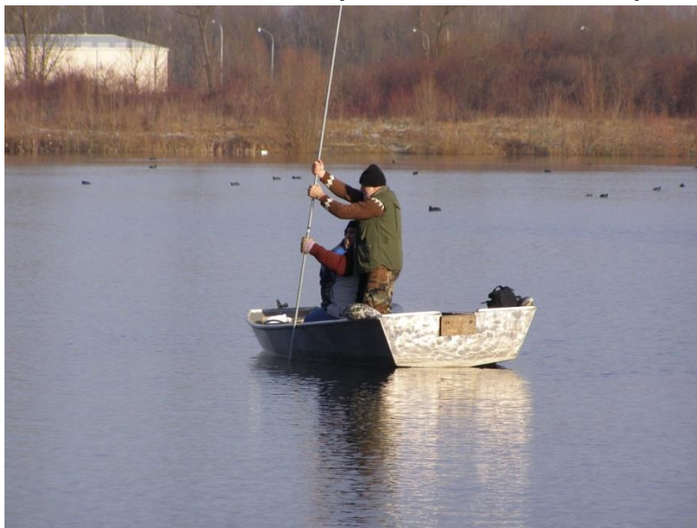
Slika 5. Uzimanje uzoraka mulja sondom s dna jezera
